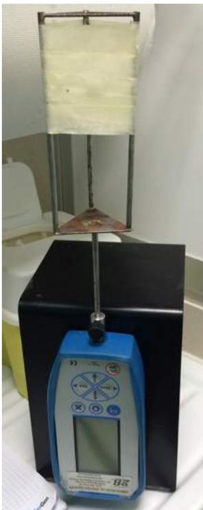
Fig. 5 Il dinamometro per grasping test.
